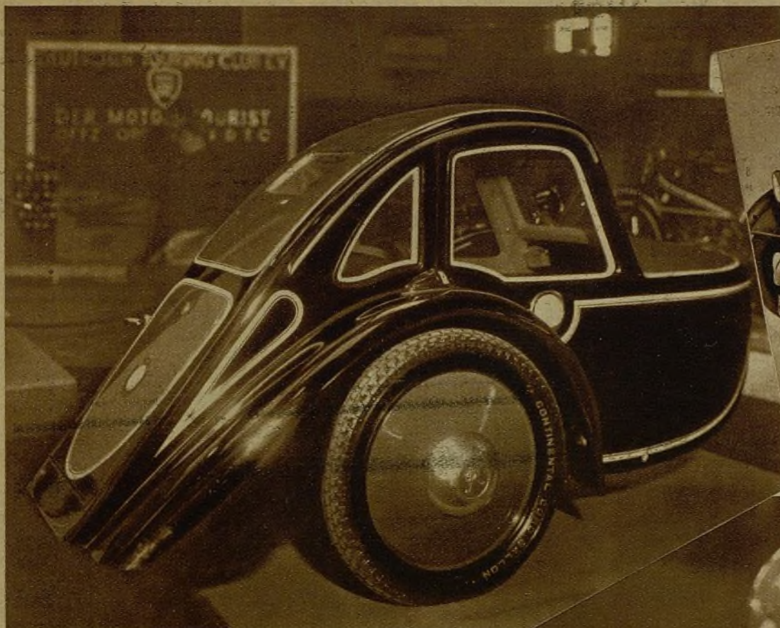
En esta carrocería de un ciclomotor se han llegado a extremos notables de aprovechamiento del espacio y de la supresión de planos de resistencia al aire.—(Fotos Orrios y Norbert Ebel)
