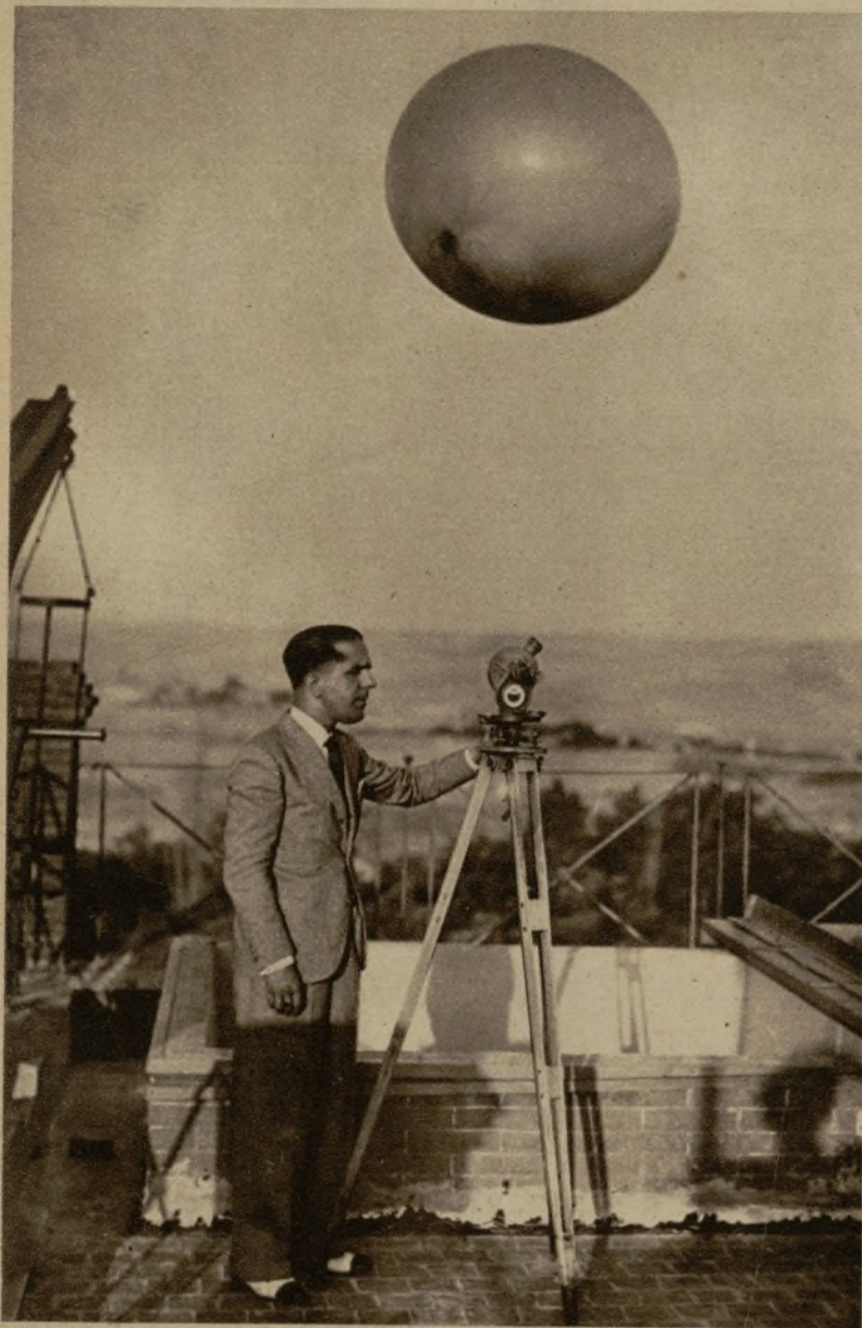
Todos los días, a las seis de la tarde, se da suelta en el Observatorio Astronómico a un globo como éste. Su ascensión es seguida por el teodolito, y sirve para indicarnos la altura de las nubes
