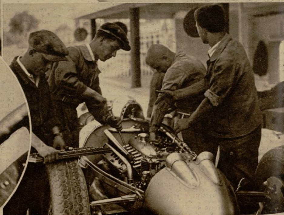
Los mecánicos sustituyen las bujías de uno de los Auto-Union, listos para un entrenamiento
