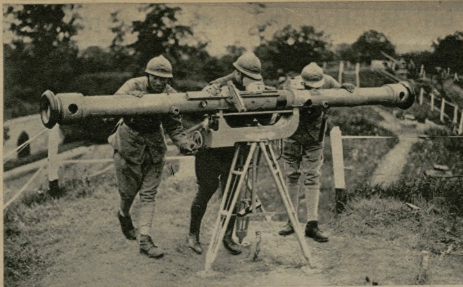
El telémetro, que sirve para determinar la distancia a que se encuentran los aviones, y que ha sido empleado con gran eficacia en las maniobras aéreas francesas
