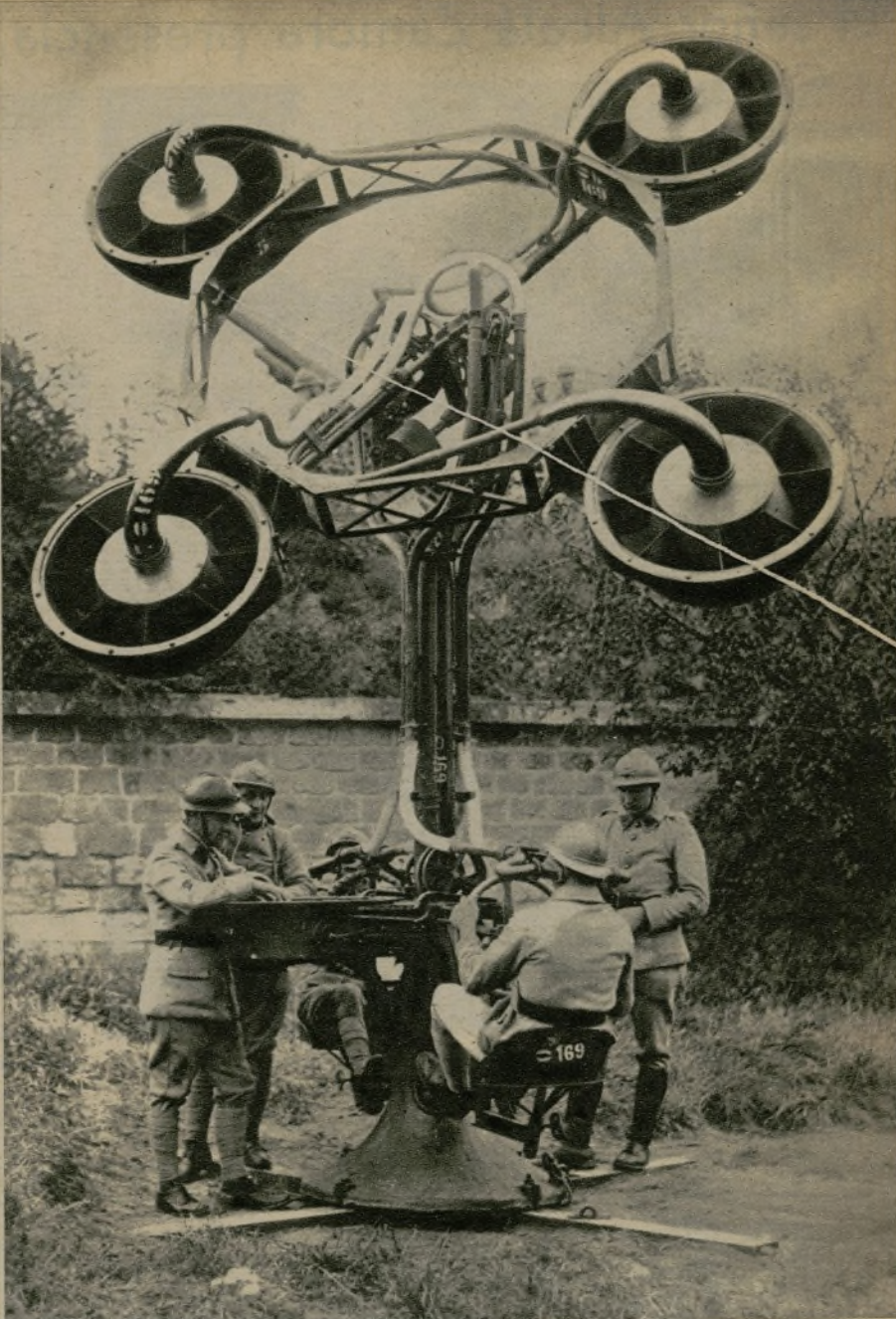
El curiosísimo aparato que se utiliza actualmente para descubrir, gracias al sonido, la aproximación de un aeroplano y determinar su situación (Fotos Trampus)
