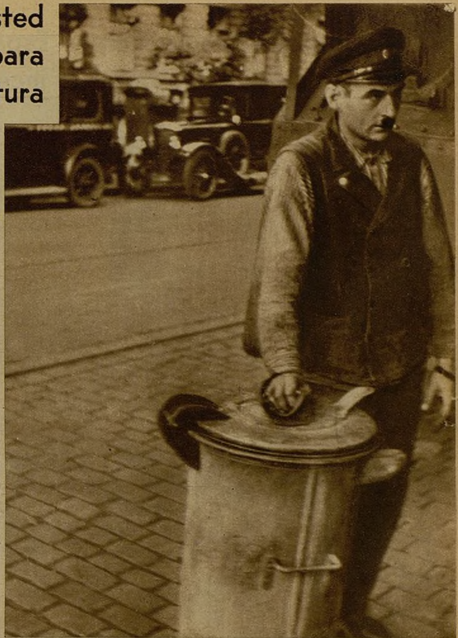
En varias ciudades de Alemania se ha llegado a una verdadera perfección en la técnica de la recogida y aprovechamiento de basuras. En las puertas de las casas aparecen en las madrugadas estos depósitos, que pueden vaciarse automáticamente su contenido en el tanque colector, sin necesidad de que las manos se contaminen por el contacto directo
