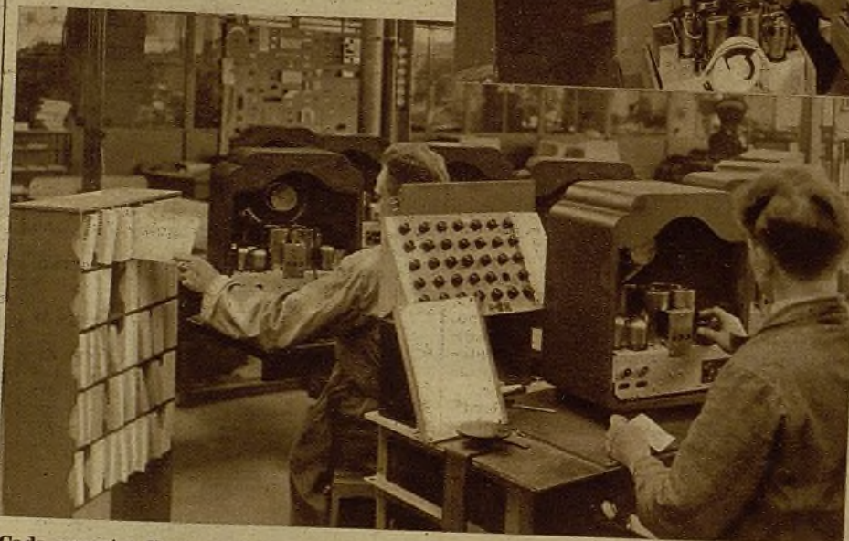
Cada receptor lleva su lista especial de emisoras, que coincide exactamente con su escala micrométrica
