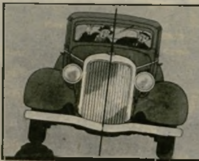
El coche corriente encuentra una protuberancia en el camino y se inclina
