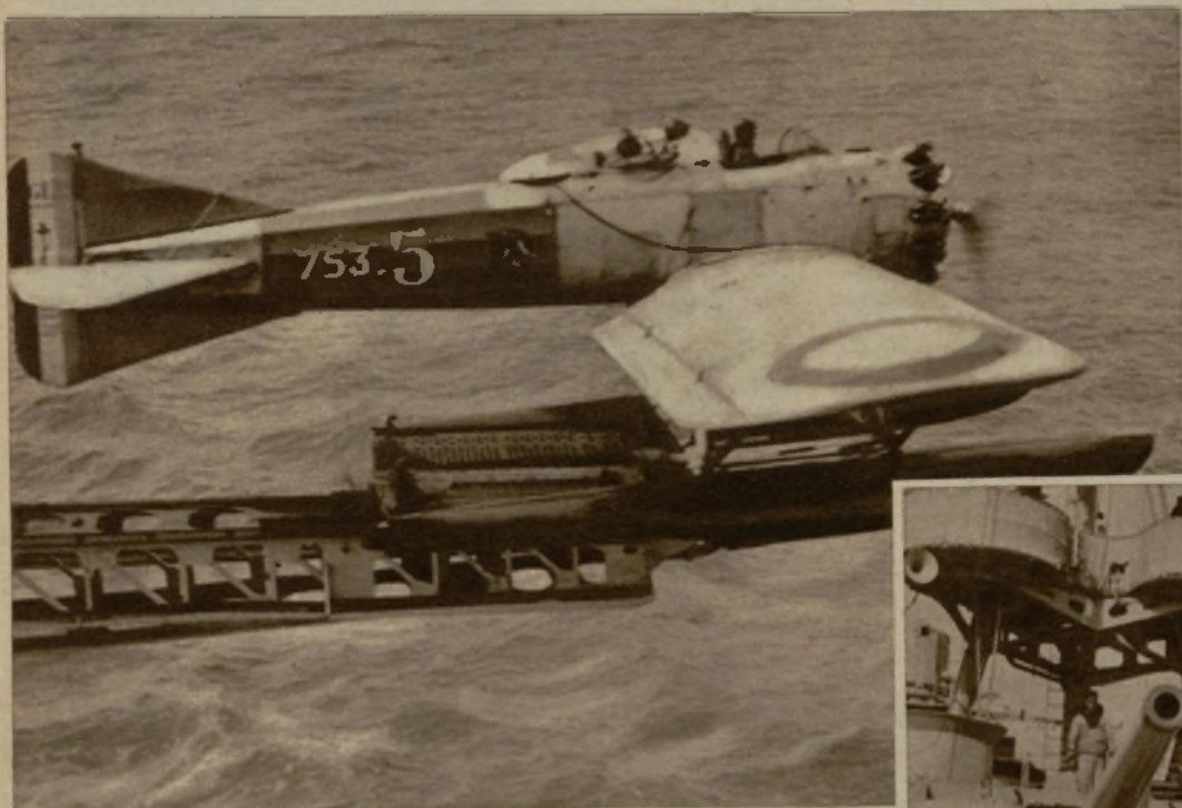
Los hidroaviones salen de los buques que los transportan, lanzados como una catapulta, en el momento en que lo ordena el mando (Fotos Contreras y Vilaseca)
