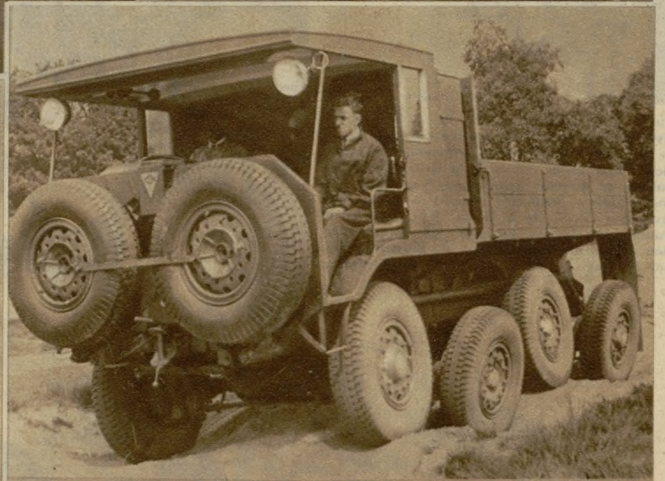
La independencia de las ruedas del nuevo tractor le permite adaptarse a las más extravagantes desigualdades del terreno (Foto Vidal)
