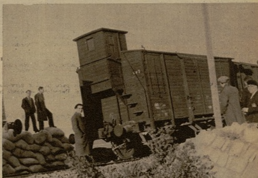
Estado en que quedaron algunas unidades de un tren de viajeros que descarriló en la estación de Chinchilla (Albacete). El accidente originó una larga paralización en el tráfico e importantes daños en el material
