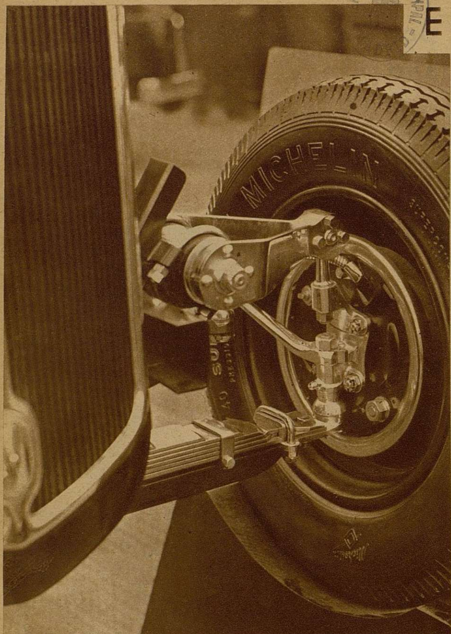
Una novedad interesante en el Salón del Automóvil es la generalización de las ruedas delanteras independientes. La suspensión, descargándose en parte hacia adelante, permite que el coche se adhiera mejor a la carretera, facilita la comodidad de los que viajan y suprime las reacciones peligrosas en el volante
