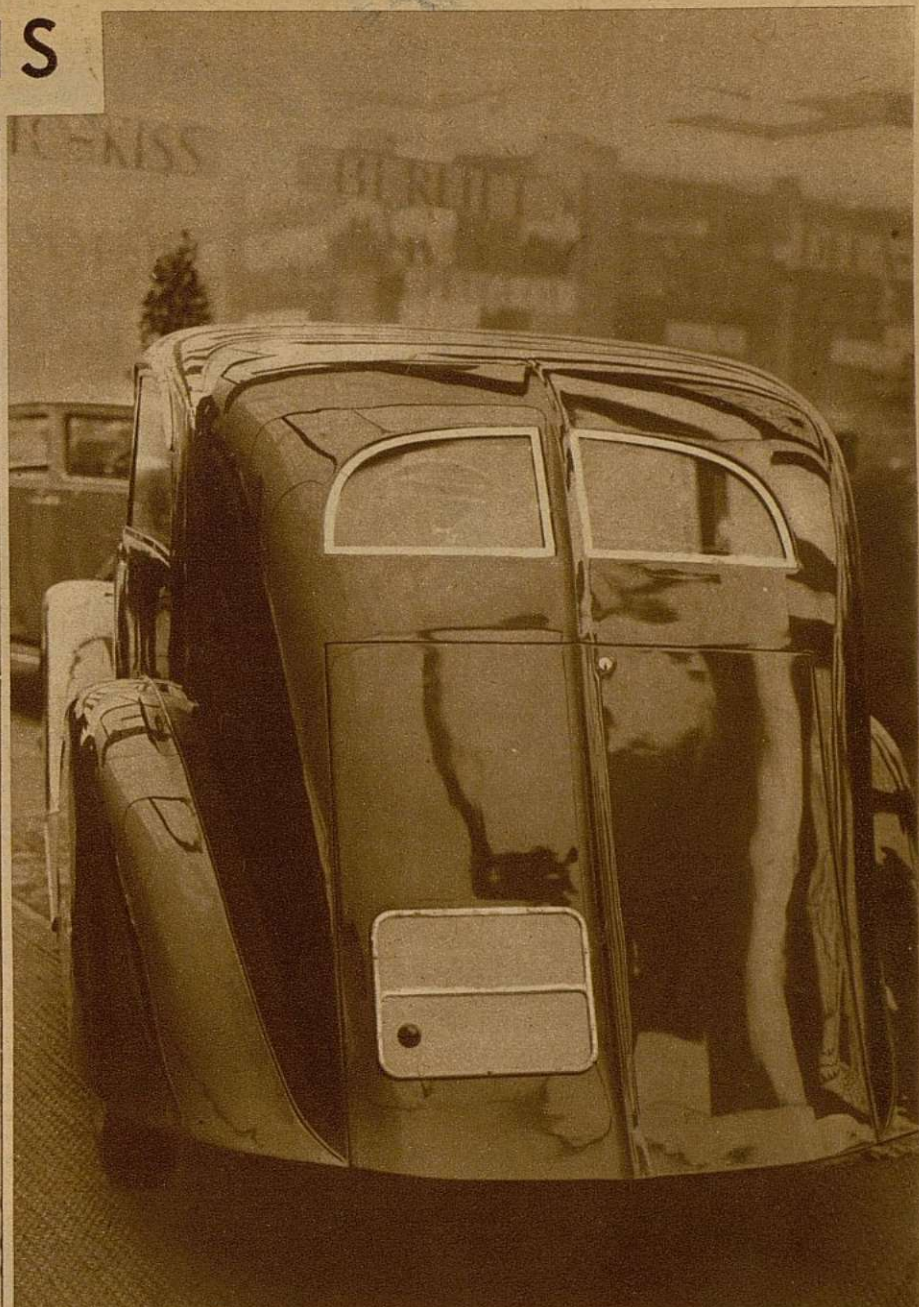
En este hueco de la parte trasera caben una rueda de repuesto, dos maletas de viaje y la caja de las herramientas: un verdadero almacén contenido en el mínimo espacio. En los chasis los constructores se han esforzado por darles la mayor rigidez, logrando así una estabilidad en la carretera que hasta ahora no siempre se conseguía
