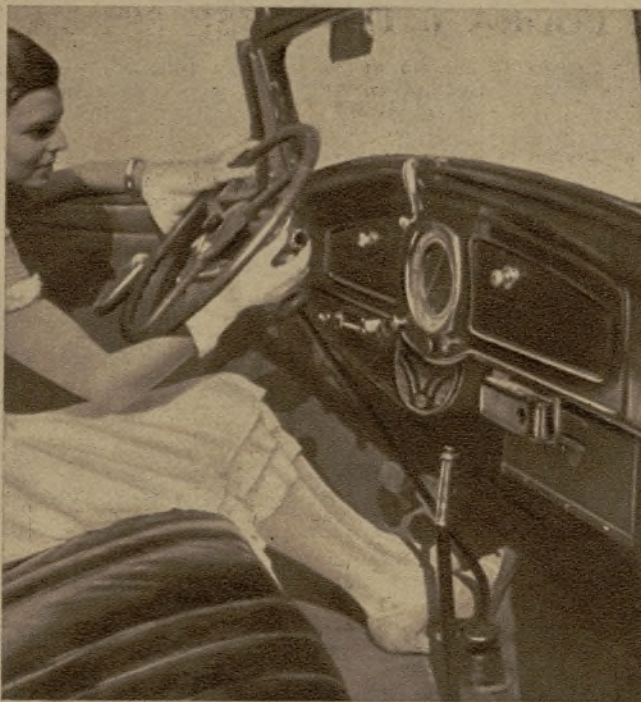
Una moderna instalación de radio en un automóvil: el mando, en el volante; el altavoz, en el centro, y el receptor, a la derecha
