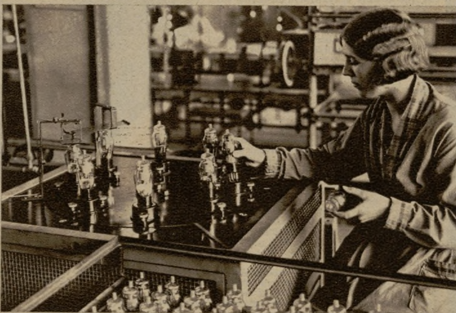
Sometiendo la válvula octodo a un sistema inductivo de calefacción que suprime todas las posibles impurezas
