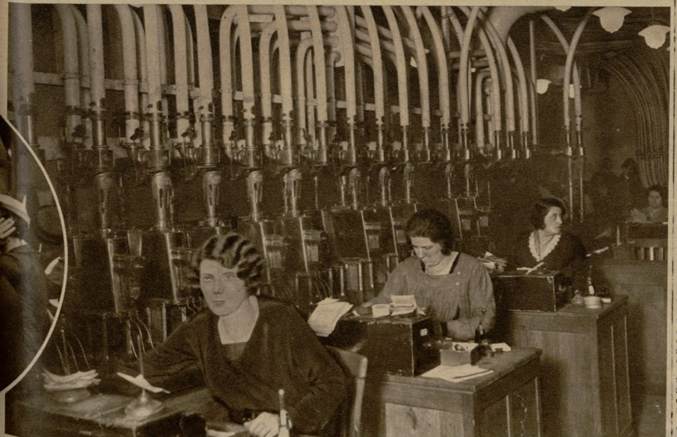
En uno de los grandes almacenes, un dispositivo permite el pago en cada sección sin necesidad de acudir a la caja. El dinero entregado por la cliente va, por medio de unos tubos neumáticos, al "servicio central", desde donde es devuelto en el acto el cambio con la factura
