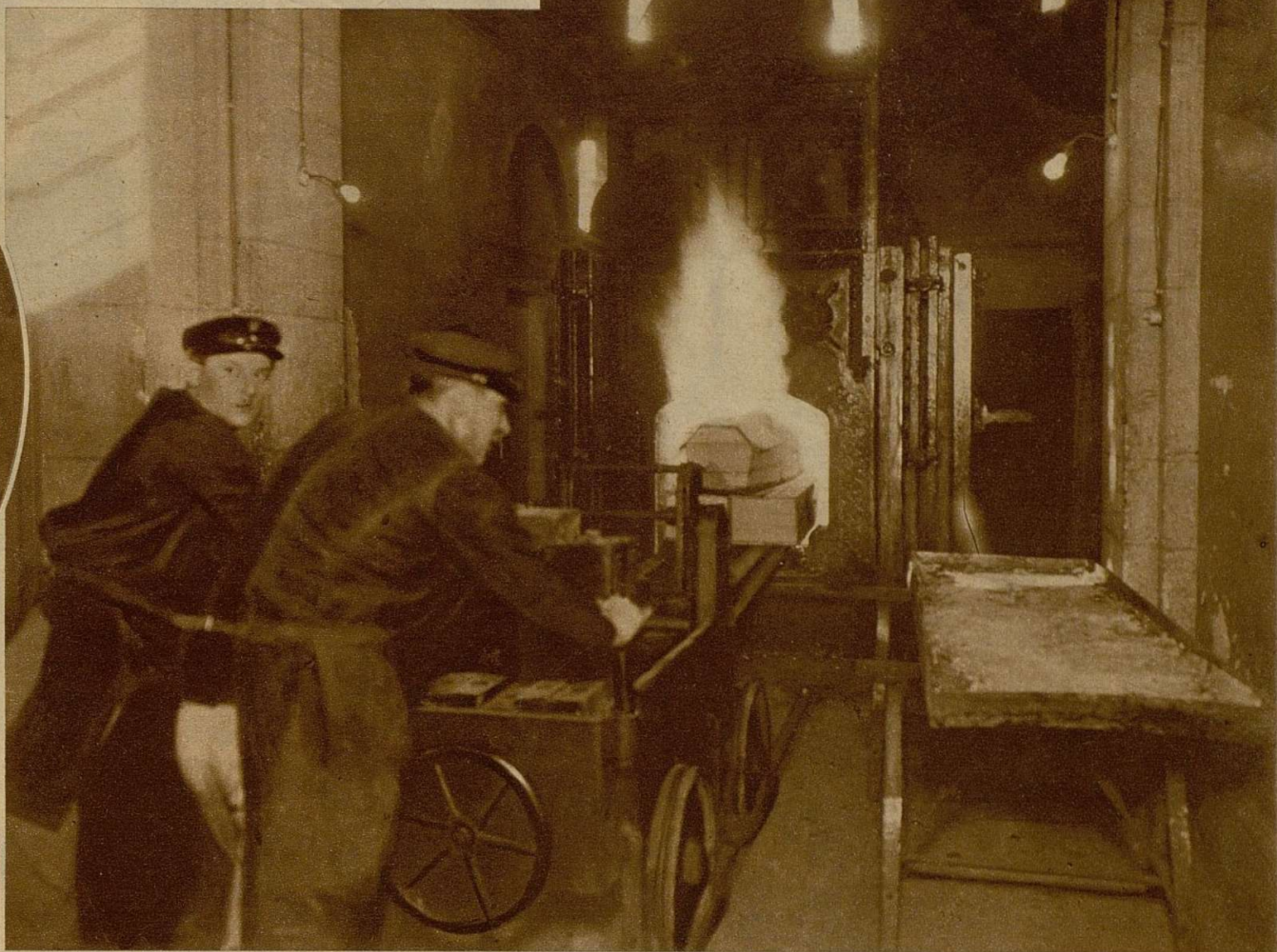
Los obreros encargados de las prácticas crematorias han recogido la caja que contiene el cadáver y la introducen en el horno, a 1.400 grados de temperatura. La caja se transforma en un polvo negro, y el cadáver en un montoncito de cenizas blancas de 1.500 gramos de peso
