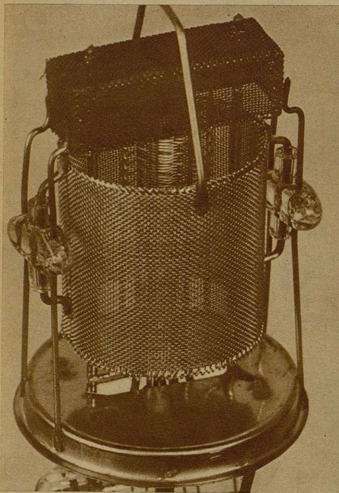
Interior de la nueva válvula, pentodo de alta frecuencia E. 446
