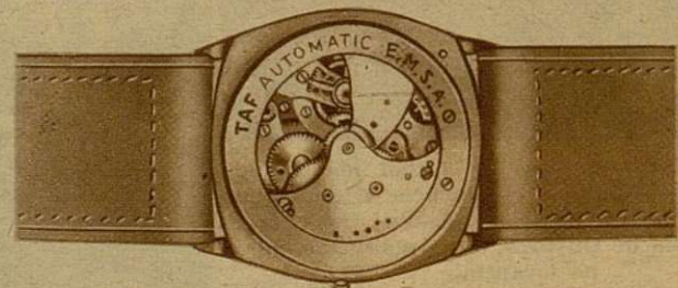
(aspecto del reloj automático sin la tapa)
