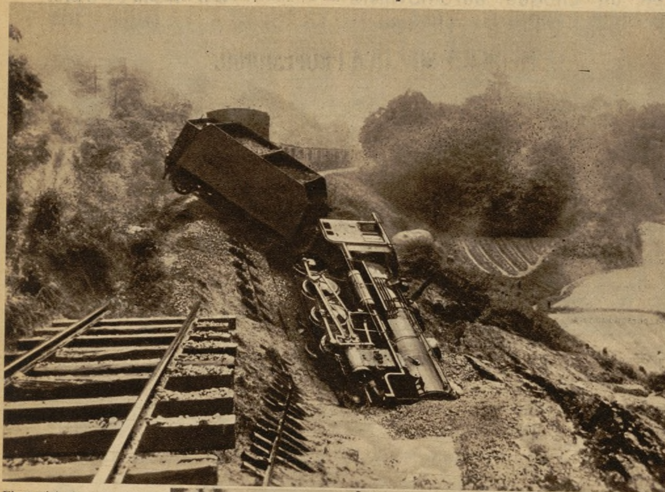
Vagones del tren que descarriló en la línea Kurume-Oita a causa de un desprendimiento de tierras
