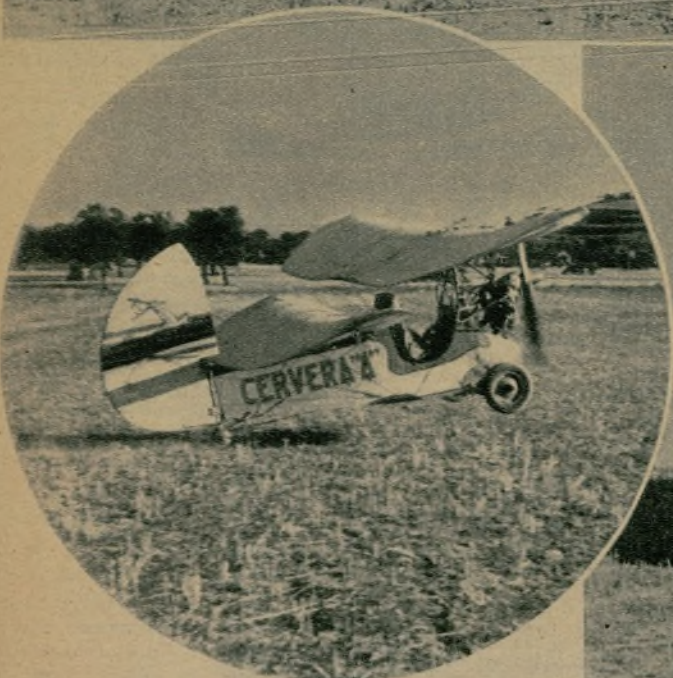
Después de correr a lo largo del campo, se ha decidido modificar el centrado y mover algunos centímetros la posición del ala delantera
