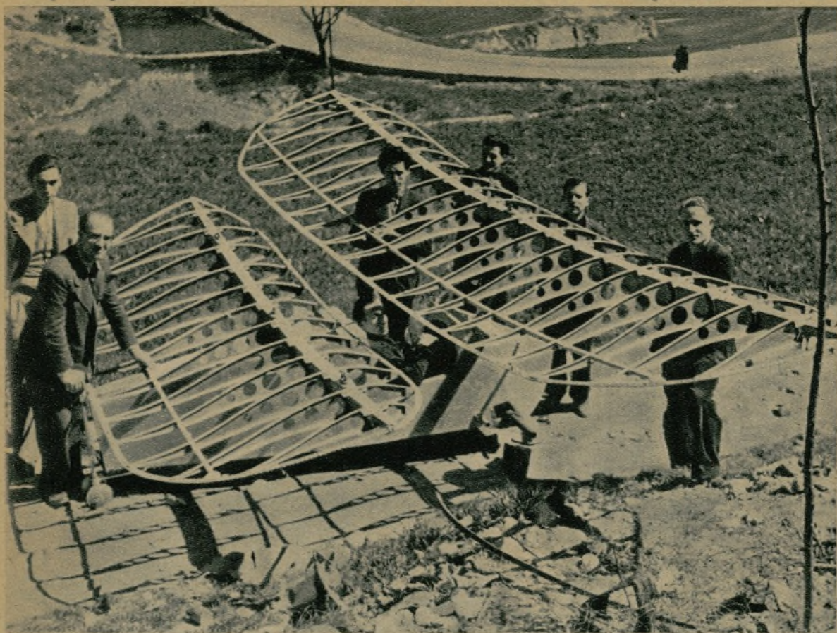
El esqueleto del pequeño y original avión, que da ya idea de su especialísima estructura
