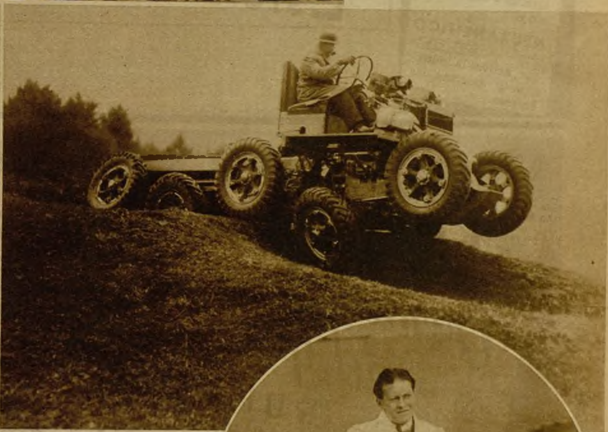
Para este monstruo de diez ruedas, que acaba de lanzar una firma especializada en "pesos pesados", no hay malos caminos. Puede trepar por rampas de gran desnivel y cruzar zanjas profundas sin que el "chasis" pierda en ningún caso la posición horizontal. — (Foto Vidal)
