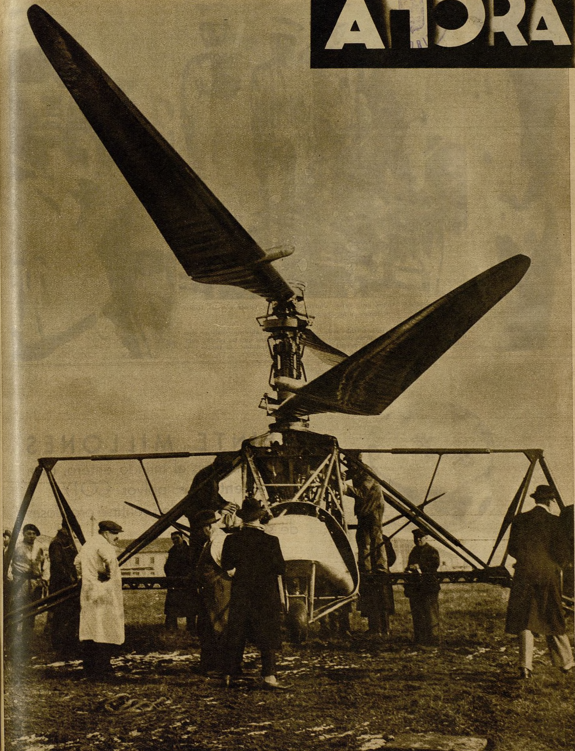
EL GIROPLANO, EL APARATO QUE REVOLUCIONARA LA AVIACION. — He aquí al giroplano Breguet-Dorand, al que se acaba de conceder el premio de un millón de francos del Ministerio del Aire, de Francia. Ha batido el "record" de vuelo en circuito cerrado del helicóptero, y puede realizar el vuelo en sentido vertical y permanecer inmóvil en el aire.
