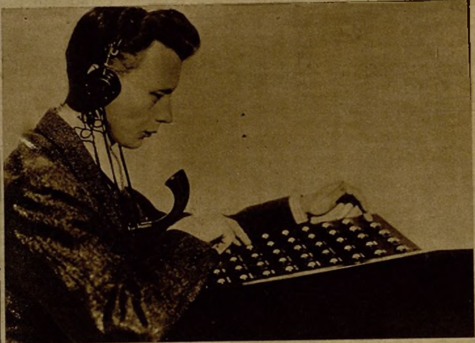
Cuadro de mando de micrófonos construido especialmente para el Congreso de la Convención Nacional Republicana, en Cleveland, que permite unir 54 micrófonos a las redes de emisoras
