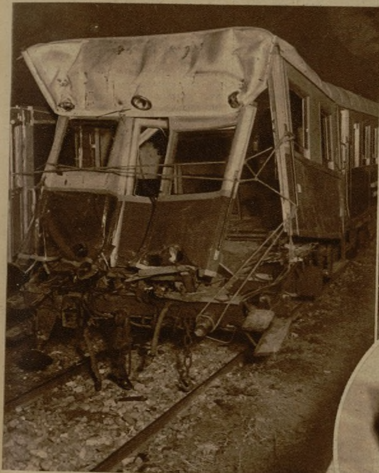
Estado en que quedó el coche automotor que se estrelló contra un vagón al entrar sin frenos en la estación de Valencia
