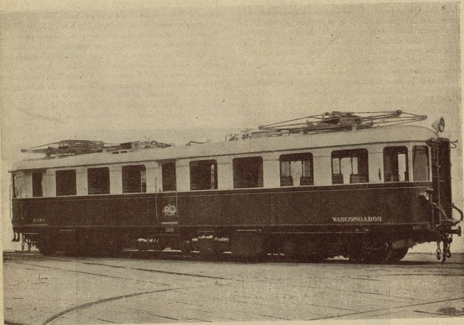
Ferrocarriles Vascongados. — Automotor Ganz, 420 HP, 1.500 voltios.
