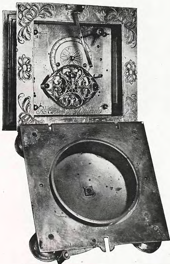
Lámina 4.--Detalle de la platina, con el puente de volante calado y cincelado. Campana de la sonería, de horas y cuartos, alojada entre las patas.
