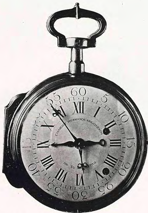
Lámina 1. - Reloj de carroza, reproducido a mitad de su tamaño natural, con repetición forzada y despertador, firmado en la esfera: Charost Hermanos Reloxeros (sic) de Su Magestad , y en la platina: En Madrid. Rl. Escuela . Caja de plata lisa. Escape de paletas y rueda catalina. Diámetro, 152 milímetros. (Pertenece a la desaparecida colección Dusmet, de Madrid.)
