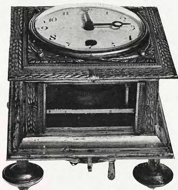
Lámina 3. - Reloj de sobremesa, horizontal, de bronce dorado y cincelado, en planta cuadrada. Caras laterales en cristal, dejando ver la maquinaria, montadas sobre esquinas decoradas con bandas verticales de hojas. Este mismo adorno de guirnalda de laurel se repite en la moldura superior que enmarca la esfera. Firmado en la platina: Charost RI. Escuela Madrid . Medidas, 85 por 85 milímetros. (Colección Pérez de Olaguer. Barcelona.)
