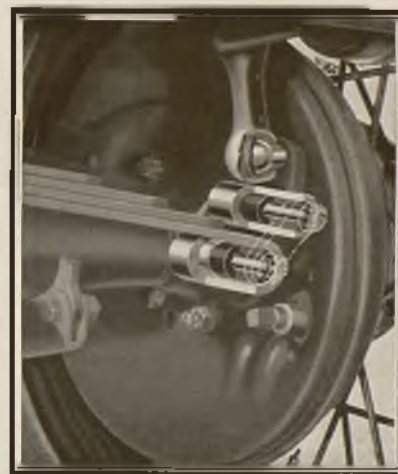
La protección de goma de las ballestas y los brazos de los amortiguadores evitan desgaste, no necesitan engrase y facilitan el funcionamiento
