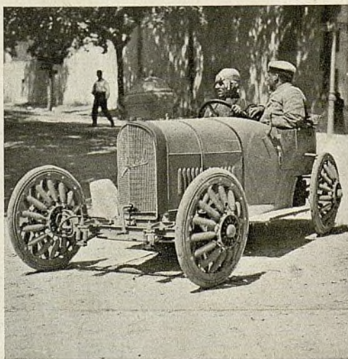
Las nuevas ruedas elásticas, inventadas por el señor Durán, aplicadas al cochecito Ideal con el cual se efectuaron interesantes experiencias
