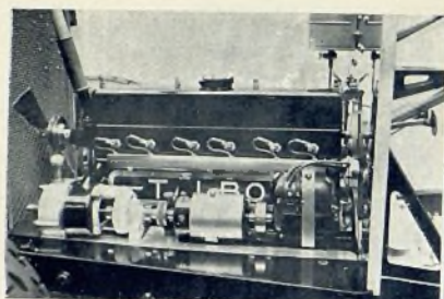
Motor Talbot 6 cilindros
