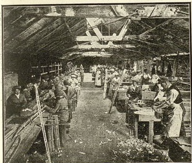
ASERRANDO Y AJUSTANDO LAS VARILLAS PARA EL ARMazón.
