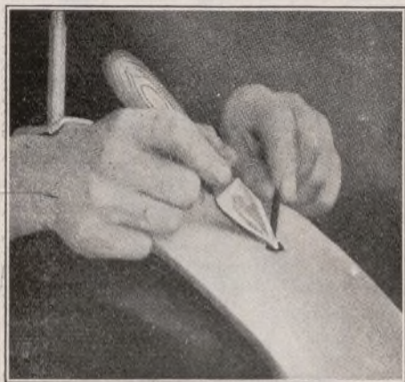
Rellenando el orificio con goma laminada sin vulcanizar.
