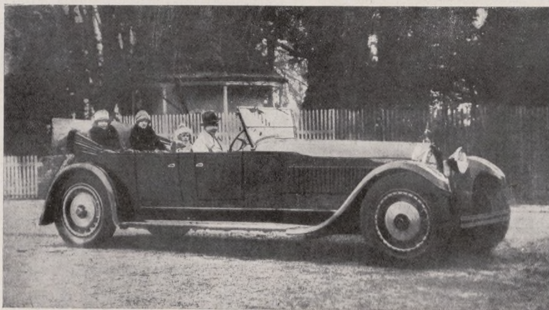
El Bugatti Real. —Este formidable ocho cilindros en línea, de 14 litros de cilindrada y más de 300 C. V. de potencia, deja pálido al Daesemberg del Salón de Nueva York que sólo tiene siete litros escasamente, con sus 265 C. V. Según leemos en una revista extranjera, el primer Bugatti Real está destinado a S. M. Don Alfonso XIII.
