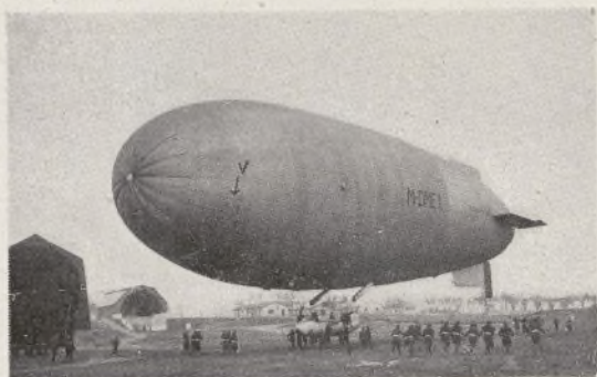
Con buena vista se pueden distinguir las válvulas V de salida del gas.
