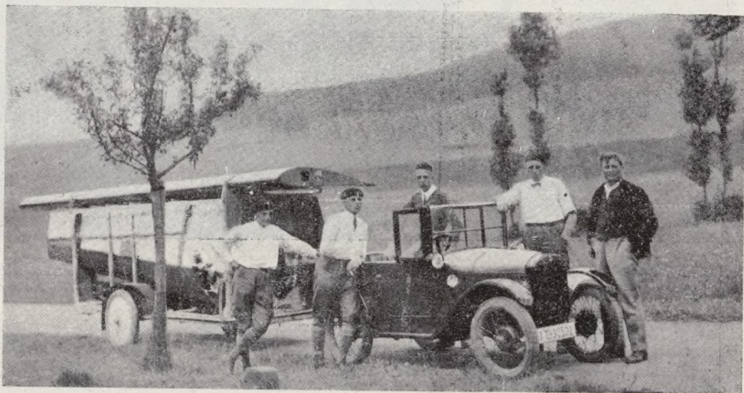
El aparato es fácilmente transportado, con las alas plegadas, en un carretón arrastrado por un pequeño coche.
