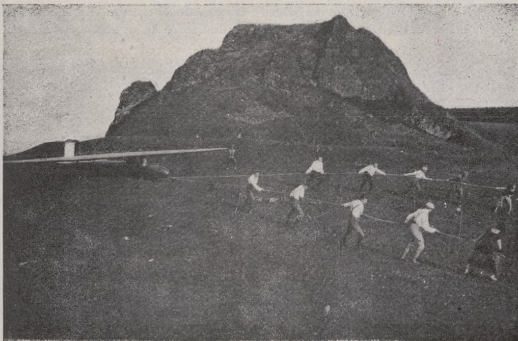
Los de la cola lo retienen fuertemente, los de los sandow tiran, andando, tensando.
