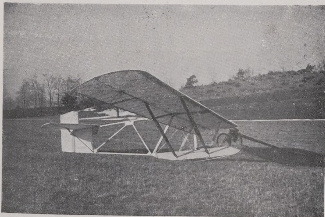
El típico planeador "Zogling", de primeras letras", con su carro de transporte.
