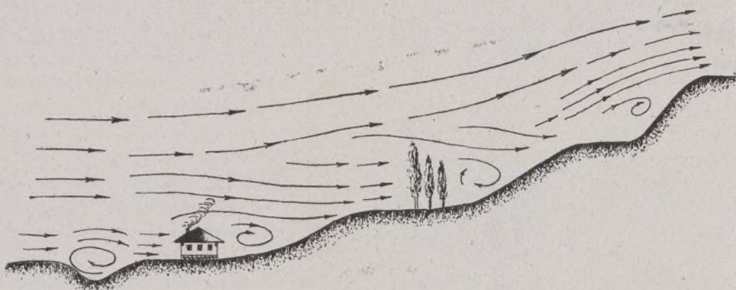
Gráfico de los remolinos que forma el viento a su paso por la pendiente de un cerro, con obstáculos al intentar remontarlo.
