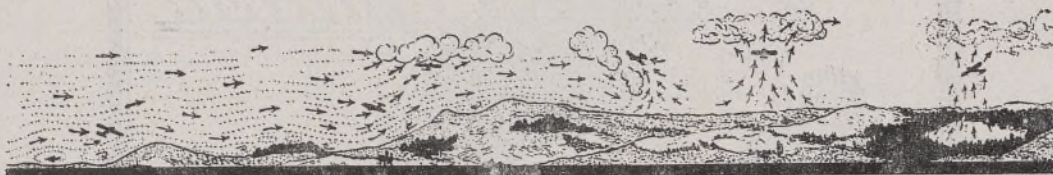
Este diagrama muestra la forma en que las corrientes de aire siguen los relieves del suelo, así como las corrientes ascendentes que se producen bajo los cúmulos.
