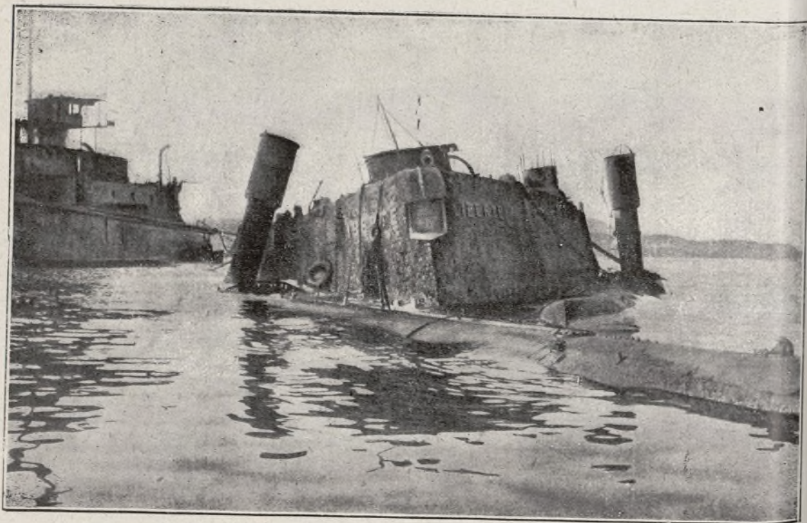
El acorazado Libertad , hundido en la rada de Tolón el 25 de Septiembre de 1911 por efecto de una explosión, y sacado a flote, por procedimientos modernos, en el presente año. El nombre del navío, en letras de cobre, aparece en la popa cubierta de cieno y de conchas. En primer término uno de los submarinos utilizados como flotadores. A la izquierda el viejo crucero Latouche-Treville , utilizado como dique flotante.
