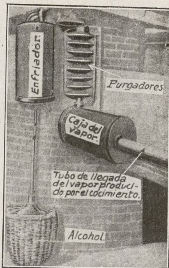
El aparato que sirve para extraer el alcohol durante la cochura de la pasta de pan
