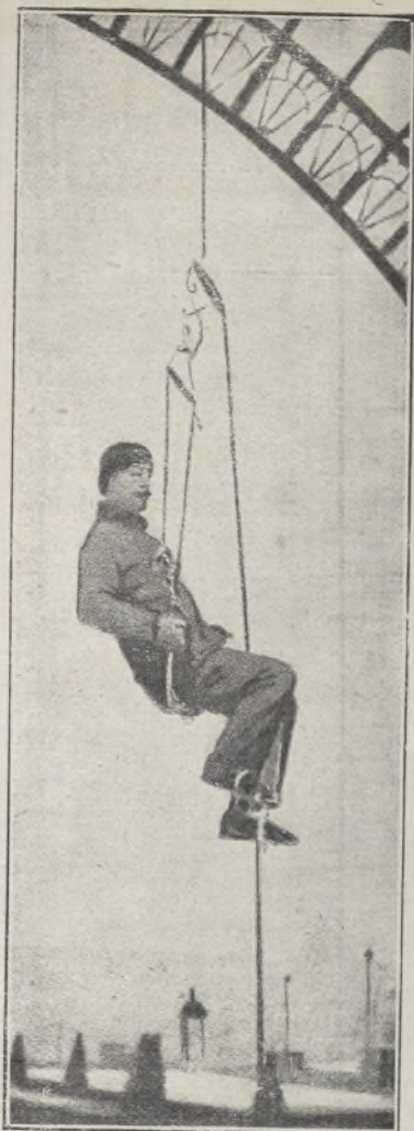
Un hombre provisto del Oustiti trepador puede, en cualquier momento dado de su ascensión o bajada, detenerse y quedar sentado en el aire como si estuviera en un cómodo sillón.
