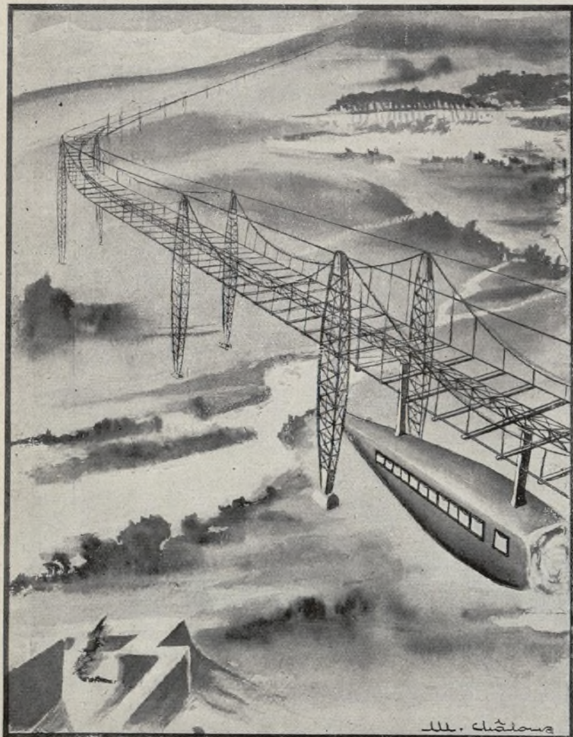
Proyecto de ferrocarril francés.—Esta vía aérea y soportada por torres metálicas de 150 metros de altura permitirá obtener velocidades de 250 kilómetros por hora.
