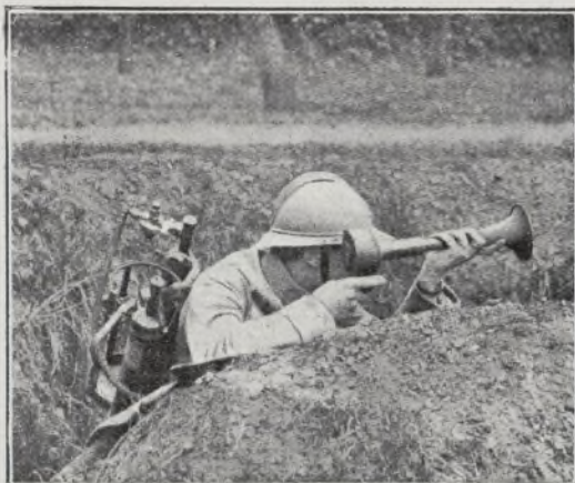
Clarín de aire comprimido que se emplea como aparato de señales.
