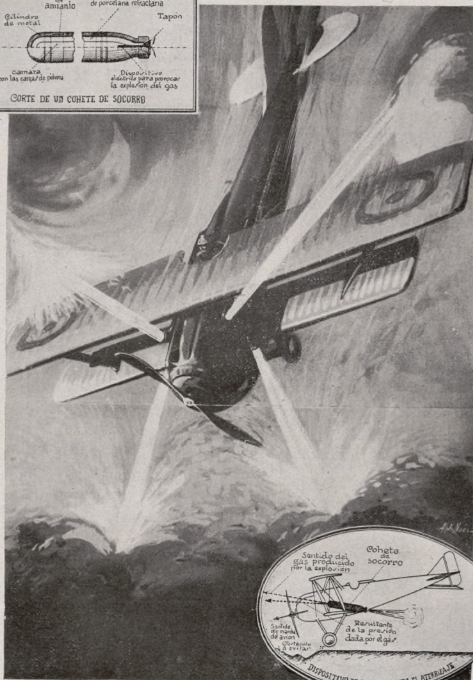
Gráfico y explicación de un avión que, gracias al invento del Capitán Alberto Lepinte, en plena caída recobra su estabilidad por medio de la explosión de cuatro cohetes.
