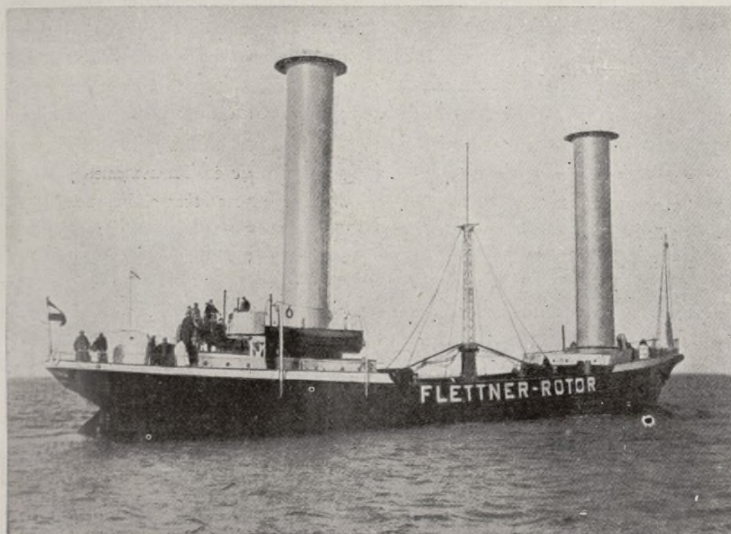
El Buckan, navío de viento con dos rotores sistema Flettner.
