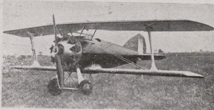
Biplano de caza, con quilla de madera, que soporta 1.260 kilogramos de carga total y se eleva a 8.500 metros, marchando a 200 kilómetros por hora.
