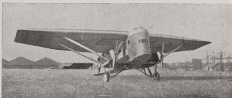
Monoplano de cuatro motores, acoplados de dos en dos, empleado para transporte: admite 800 kilogramos de carga comercial y 12 pasajeros en la cabina situada en la parte posterior; marcha a razón de 170 kilómetros por hora.
