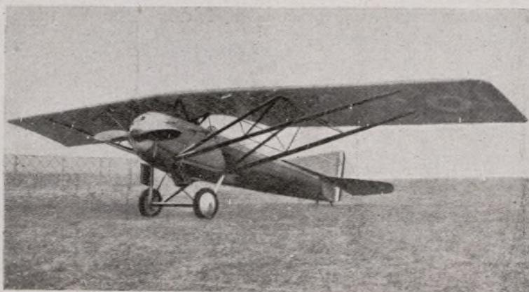
Monoplano de caza, de construcción metálica, que puede elevarse a 12.000 metros, para lo cual dispone el piloto de un inhalador de oxígeno; a 7.000 metros, alcanza velocidades de 260 kilómetros por hora y soporta un peso total de 1.500 kilogramos.
