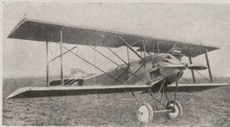
Biplano de construcción mixta, con la cabina del motor forrada de aluminio endurecido, susceptible de llevar 950 kilogramos de carga total, de ella, 120 de combustible, alcanzando velocidades de 170 kilómetros a la hora y alturas de 5.500 metros.
