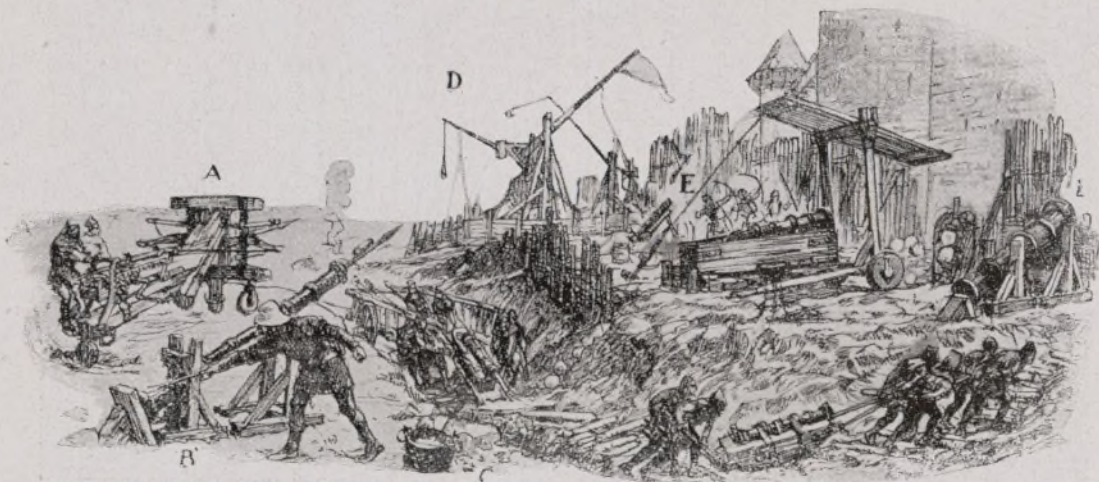
Artillería de sitio, siglo XIV. —A, Torre balista.-B, Cañón para lanzar dardos incendiarios, fuego griego o piedras contra las murallas.-C, Horno para cargar las bombas.-D, Torre lanzadora de piedras.-E, Bombardas de pequeño calibre.
