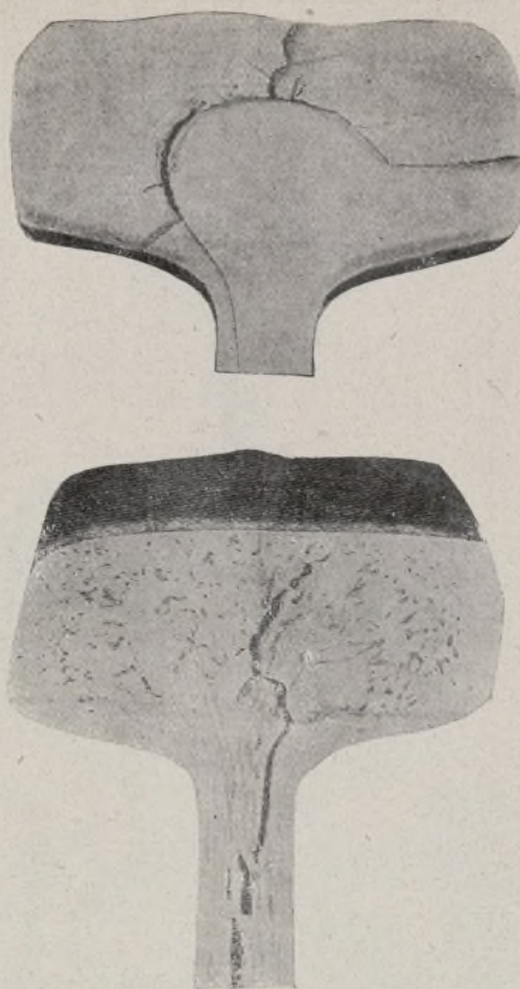
He aquí dos cortes de rieles, que al parecer perfectamente buenos, tienen sin embargo grietas interiores que acortarán su vida.
