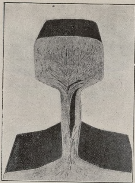
Una burbuja de gas que quedó en el momento de la formación del lingote se ha convertido en esta grieta que inutiliza el rail.
