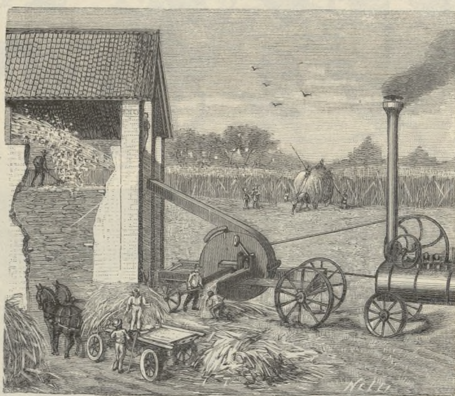
Fig. 25. - INFOSAMENTO FORAGGI. Trinciamais Albaret in azione.
