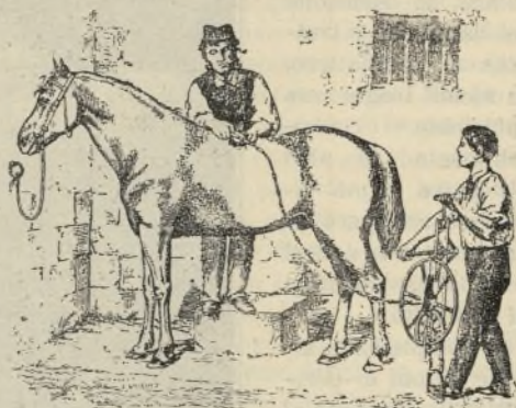
Fig. 4. — Tosatrice in azione.
