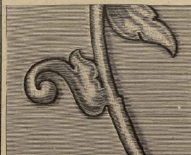
31. Niederschlagen des Grundes neben den Schnittlinien. Siehe auch Abb. 30.
