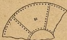
Figs. 72 y 73.—Trozos del casquete del mismo generador de las figs. 70 y 71.
