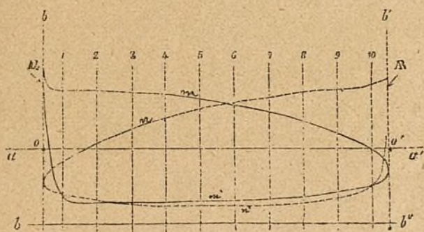
Fig. 83.—Diagramas de ambos lados del émbolo.
